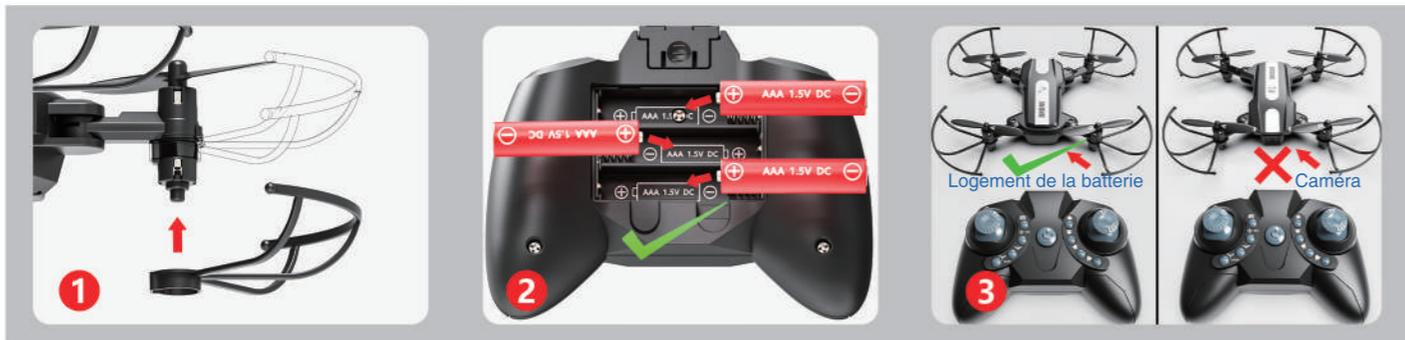
1 Installez les 4 protections sous les sièges du moteur comme indiqué ci-dessus.
