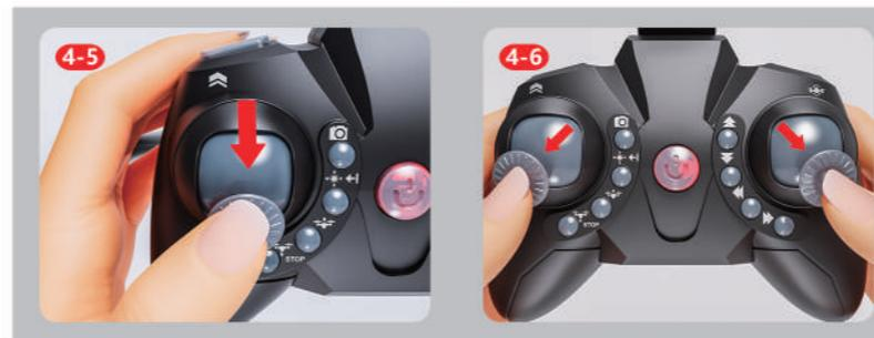
4-5 Poussez le joystick gauche une fois vers le bas. (À ce stade, la lumière rouge de la télécommande et du drone reste allumée, ce qui indique que la télécommande est connectée au drone).
